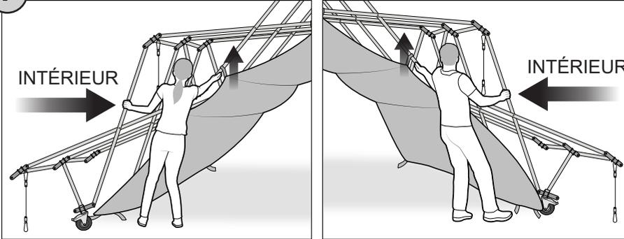
8 Connectez le câble de sécurité entre deux rotules intérieurs
